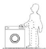
Fig. 6 - Percorso della corrente
