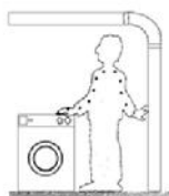
Fig. 5 - Percorso della corrente
